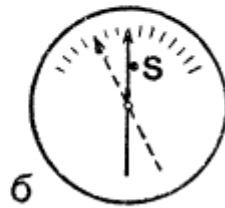
Рис. 175. Схема опыта, выясняющего направление э. д. с. самоиндукции.
